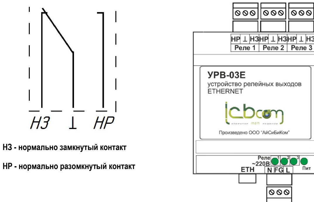
Рисунок 2 – Схема конфигурации выводов реле и схема устройства
